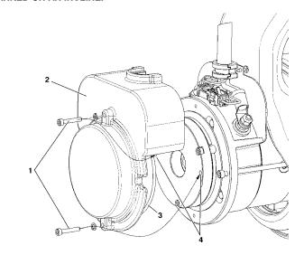
Figure 4-5. Manual Disengage
