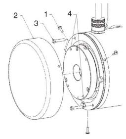
Figure 4-4. Manual Disengage
